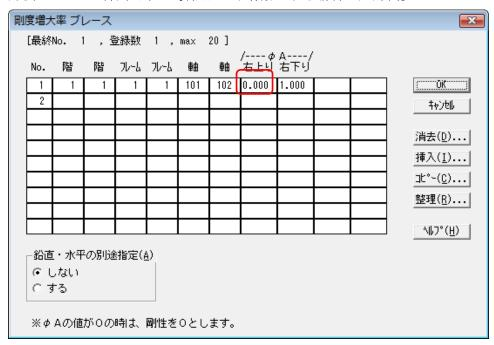
引張りのみ有効な×形ブレース([6.4.1 断面積登録]で "タイプ"を 4 としたブレース) に対して、片側のブレースの剛度増大率  $\phi$  A を 0.000 と入力します。
